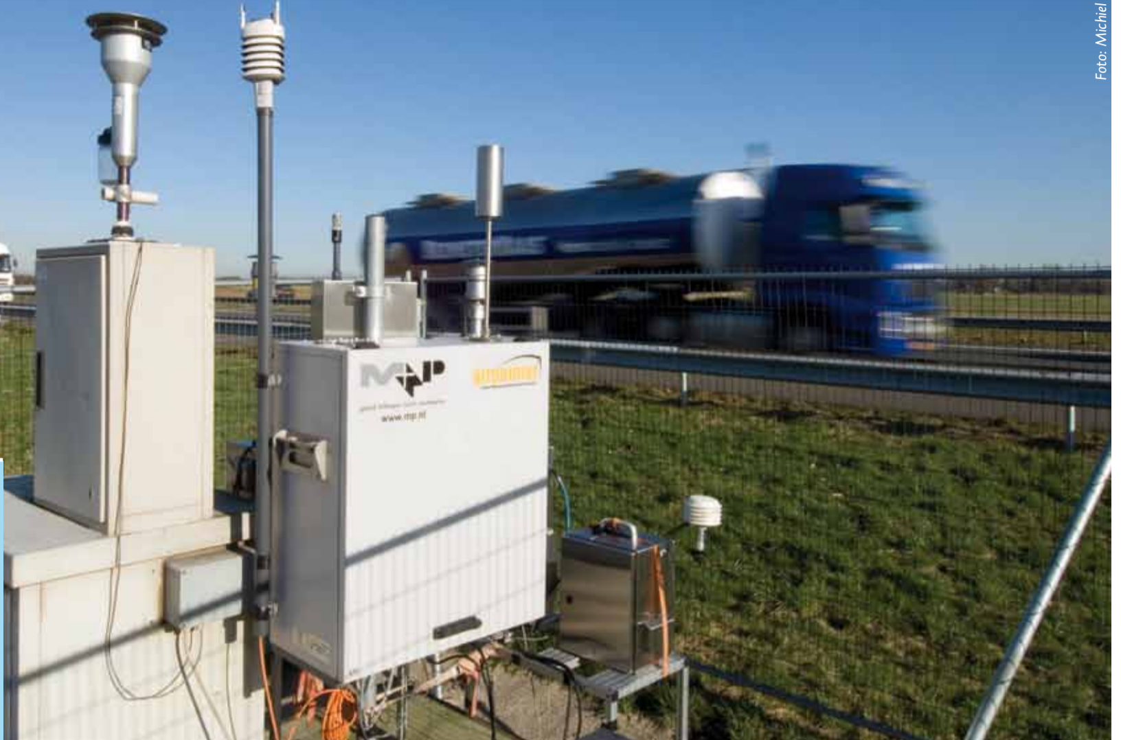
Langs de A28 bij strand Nulde wordt niet alleen de luchtkwaliteit gemeten, maar ook de invloed die schermen langs de weg hebben op de luchtkwaliteit. Er zijn schermen waar de stikstofdioxide in wordt omgezet in minder schadelijke stoffen en schermen die veel fijn stof opvangen
