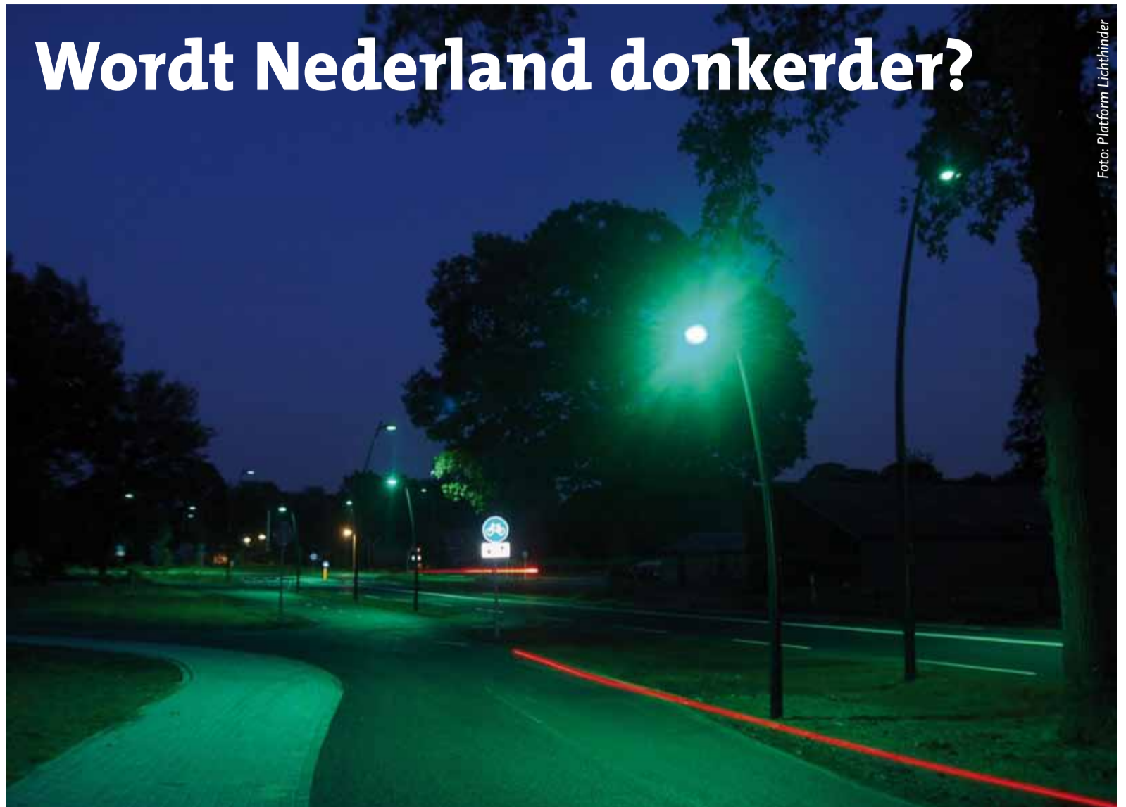
Een nieuwe ontwikkeling is het toepassen van groen licht: dit is minder lichtvervuilend en werkt op een lager vermogen
